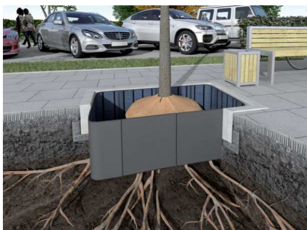
Obr. 7 kombinovaný způsob provětrávání a zalévání stromu, protikořenové panely (zdroj www.arboobchod.cz )
