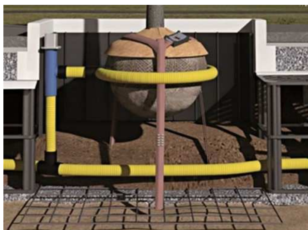
Obr. 7 kombinovaný způsob provětrávání a zalévání stromu, protikořenové panely (zdroj www.arboobchod.cz )
